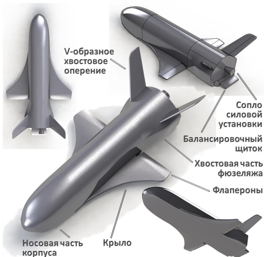
Рис. 8. Виды построенного виртуального прототипа автономного экспериментального летательного аппарата X-37
