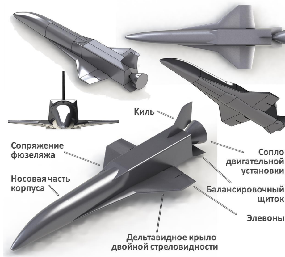
Рис. 7. Созданная реалистичная 3D поверхность летательного аппарата X-34 в различных ракурсах
