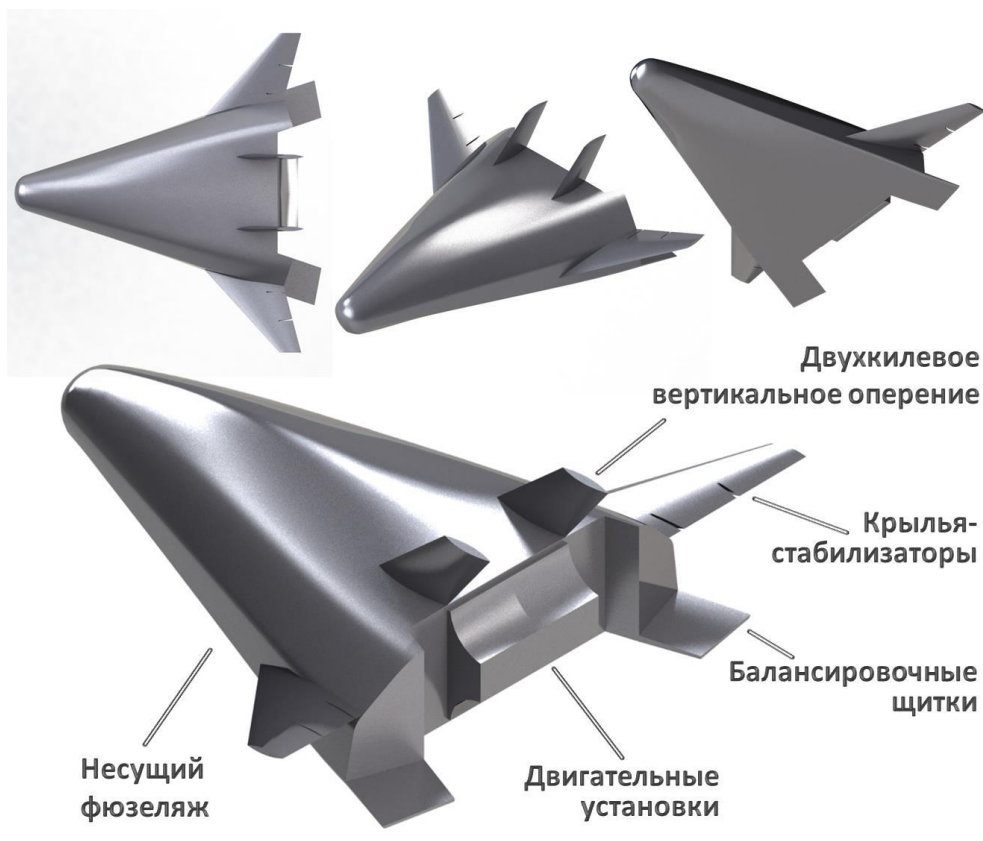
Рис. 6. Виды разработанной виртуальной поверхности летательного аппарата X-33
