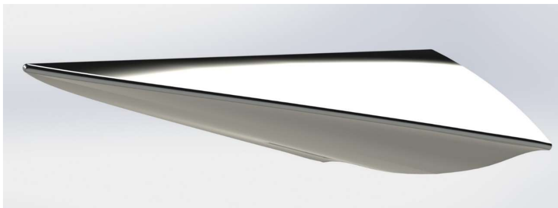
Рис. 1. Виртуальная модель волнолета с затупленными кромками
