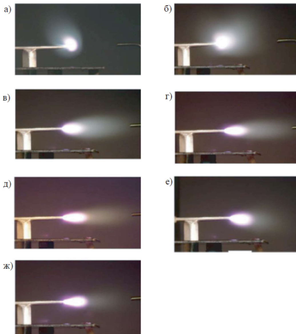
Рис. 13. Присоединенный разряд в потоке воздуха со скоростью 0 (а), 3 (б), 12 (в), 30 (г), 50 (д), 85 (е), 500 м/с (ж)
