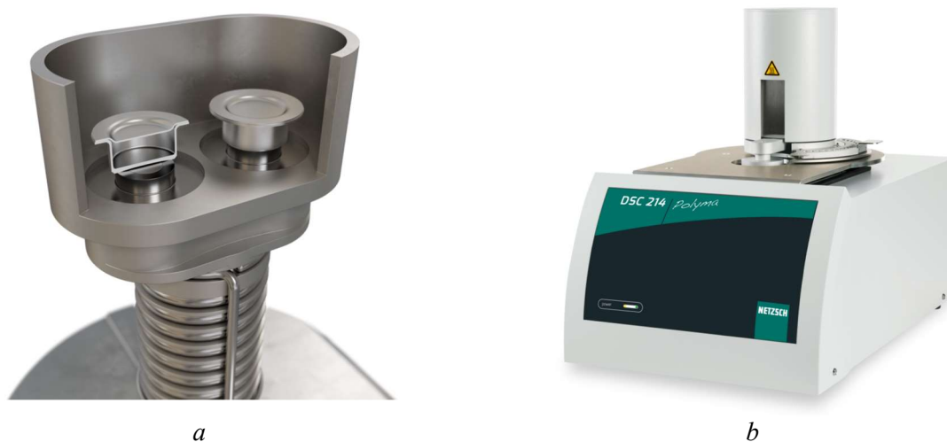
Рис. 7. Дифференциальная сканирующая калориметрия [46]: a – вид внутренней части камеры прибора DSC 214 Polyma фирмы NETZSCH, b – внешний вид прибора DSC 214 Polyma фирмы NETZSCH
