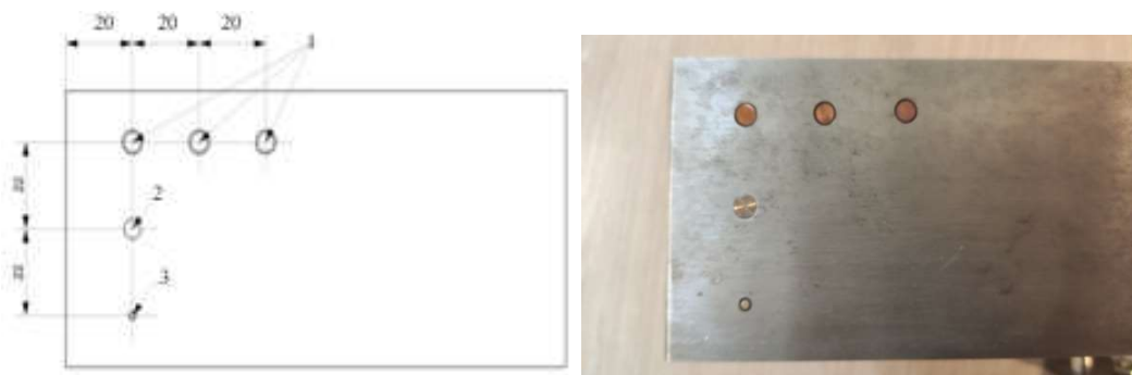
Рис. 5. Эскиз и фото нижней модели с метками установок датчиков: 1 – СТ1, СТ2, СТ3, 2– РСВ, 3 –МСТ
