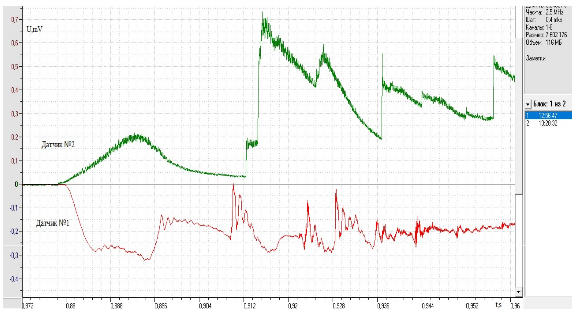
Рис. 6. Графики датчиков давлений № 1 и № 2 при P_4 = 3.6 \times 10^6 Па, P_1 = 10^2 Па
