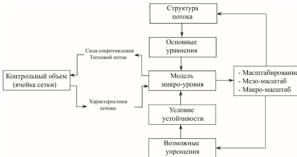
Рис. 7. Реализация многомасштабного подхода к моделированию двухфазных течений
