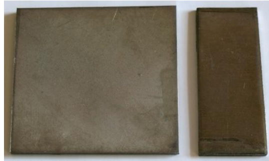
Рис. 1 Покрытие из вольфрама (слева) и карбида вольфрама (справа) на стали
