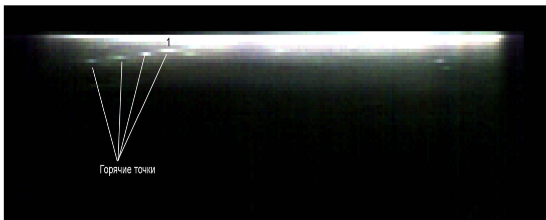
Рис. 15. Гиперспектральное RGB изображение горения смеси 40 % H_2 – воздух, инициированного платиновой проволокой, полученный при использовании модифицированного гиперспектрометра ВИД-ИКЗ, T_0=320 С, P_0=1 атм, спектральный интервал 550 \div 650 нм
