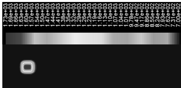
Рис. 3. Поле температур в центральном сечении в начальный момент времени при Q_0 = 5 \times 10^9 Вт/м 3
