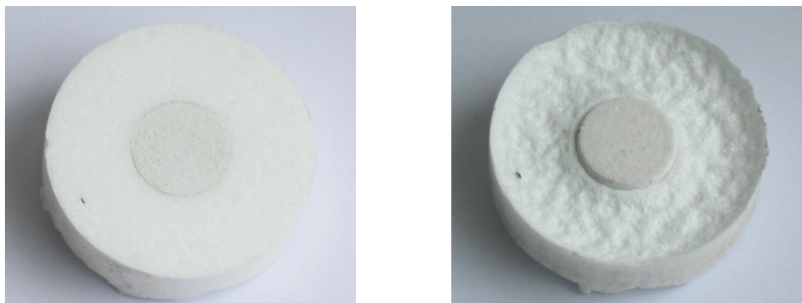
Рис. 6. Пористый Al_2O_3 в ТЗМК -10 без покрытия до и после эксперимента
