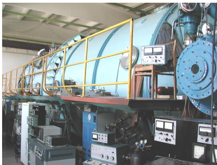
Рис. 14 Фотография вакуумной камеры установки ВИКИНГ
