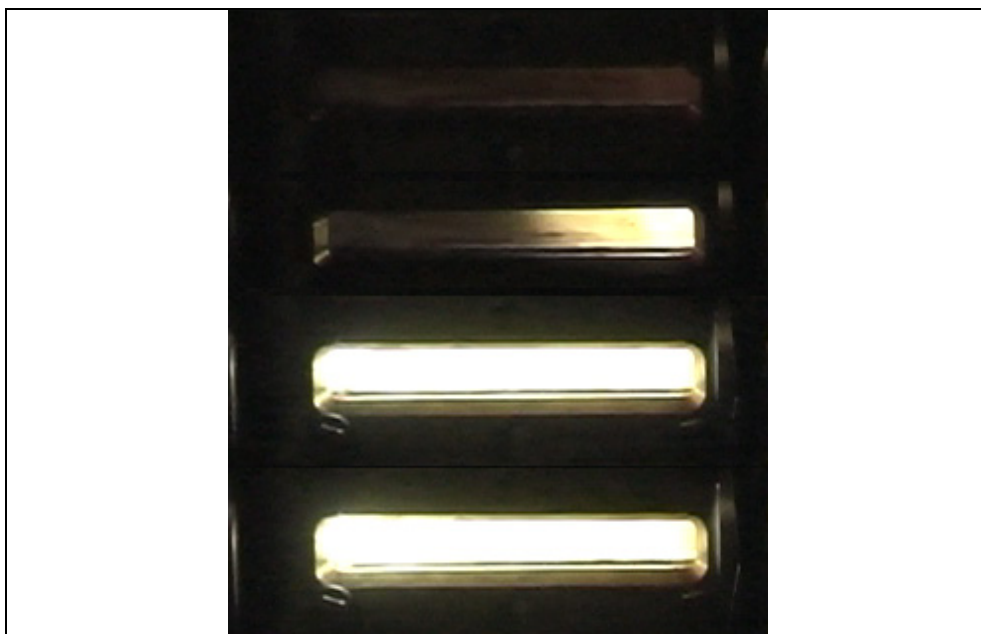
Рис.7. 4 последовательных кадра движения зоны горения вверх по потоку. Параметры воздушного потока: M=2.2 ; T_0 = 1800 К; P_0 = 7 \times 10^5 Па.
