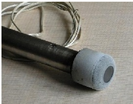
Рис.5. Общий вид державки для крепления образцов
