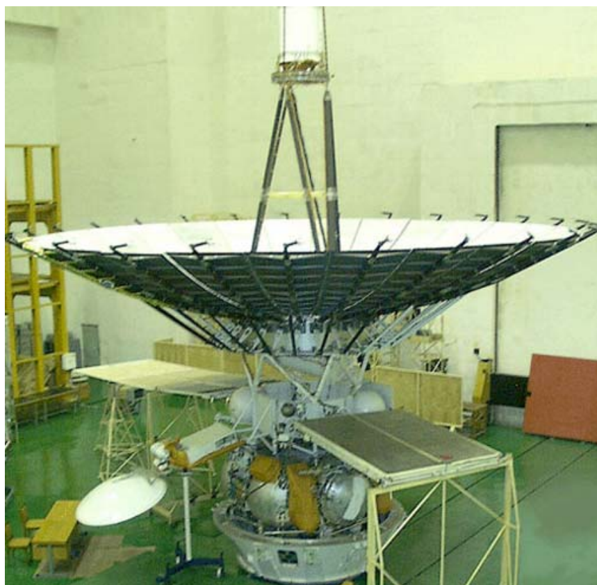
Рис.1. Вид КРТ в орбитальной конфигурации в сборочном цехе ФГУП НПО им.С.А.Лавочкина (также видны разгонный модуль «Фрегат» и адаптер к ракете-носителю)
