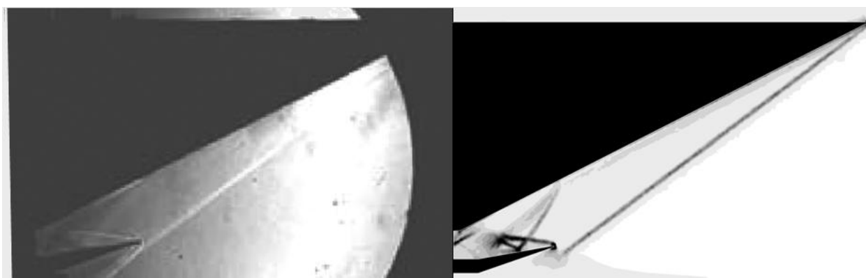
Рис. 13. Сравнение шлирен-фотографии течения вблизи воздухозаборника из эксперимента [23] и поля модуля градиента плотности расчета с использованием k\text{-}\varepsilon\text{-}\mu_t модели (2) в момент времени 1500 мкс.
