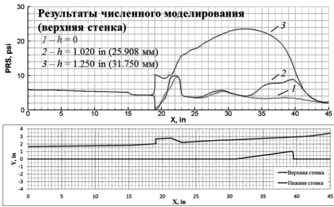
Рис. 9. Сравнение с данными лабораторных испытаний [1] для серии “холодных” пусков по распределениям давлений на верхней стенке для двух положений дроссельной заслонки: h = 25.908 мм и h = 31.750 мм
