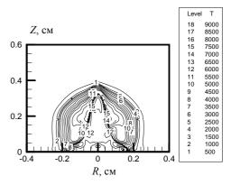
Рис.12. Пространственное распределение температуры T [K] в лазерном факеле на момент времени t=1.95 мкс ( $q_{Laz}=2\times10^7$  Вт/см $^2$ ,  $E_{Laz}=0.3$  Дж,  $t_{Laz}=500$  нс,  $P_{\infty}=0.1$  атм)
