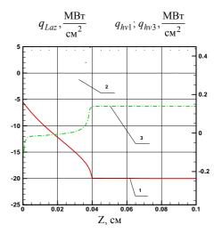
Рис.5. Распределения плотности потока лазерного излучения  $q_{Laz}$  (1) и широкополосного собственного излучения лазерного факела в спектральных группах  $hv_1$  (2) и  $hv_3$  (3) на момент времени t=0.92 мкс при воздействии  $hv_2$  — лазера ( $q_{Laz}=2\times10^7$  Вт/см²,  $E_{Laz}=0.3$  Дж,  $t_{Laz}=500$  нс,  $P_{\infty}=0.1$  атм)
