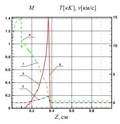
Рис.3. Распределения температуры T (1), продольной скорости v (2), числа Маха (3) в лазерном факеле вдоль оси Z на момент времени  $t=1.77\,$  мкс при воздействии  $hv_2-$  лазера ( $q_{Laz}=2\times10^7\,{\rm Br/cm^2},~E_{Laz}=0.3\,{\rm Дж},~t_{Laz}=500\,{\rm hc},~P_\infty=1\,$  атм); 4- фронт контактной границы, 5- фронт УВ
