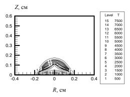
Рис.7. Пространственное распределение температуры T [K] в лазерном факеле на момент времени t=2.14 мкс (  $q_{Laz}=2\times10^7$  Вт/см²,  $E_{Laz}=0.3$  Дж,  $t_{Laz}=500$  нс,  $P_{\infty}=1$  атм)
