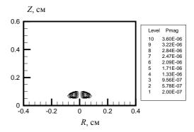
Рис.9. Пространственное распределение магнитного давления  $P_{MA\Gamma}$ [атм] в лазерном факеле на момент времени t=0.46 мкс (  $q_{Laz}=2\times10^7$  Вт/см²,  $E_{Laz}=0.3$  Дж,  $t_{Laz}=500$  нс,  $P_{\infty}=1$  атм)
