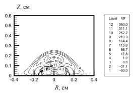
Рис.8. Пространственное распределение скорости вдоль оси v [м/с] в лазерном факеле на момент времени t=2.14 мкс ( $q_{Laz}=2\times10^7$  Вт/см²,  $E_{Laz}=0.3$  Дж,  $t_{Laz}=500$  нс,  $P_{\infty}=1$  атм)
