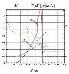
Рис.1. Распределения температуры T (1), продольной скорости v (2), числа Маха (3) в лазерном факеле вдоль оси Z на момент времени  $t=1.85\,$  мкс при воздействии  ${\rm CO_2}$ -лазера ( $q_{Laz}=2\times 10^7\,$  Вт/см $^2$ ,  $E_{Laz}=0.3\,$  Дж ,  $t_{Laz}=500\,$  нс ,  $P_{\infty}=1\,$  атм).  $4-\,$  фронт контактной границы,  $5-\,$  фронт УВ
