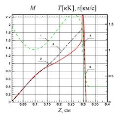
Рис.2. Распределения температуры T (1), продольной скорости v (2), числа Маха (3) в лазерном факеле вдоль оси Z на момент времени  $t=1.75\,$  мкс при воздействии  ${\rm CO_2}$ -лазера ( $q_{Laz}=2\times 10^7\,$  Вт/см $^2$  ,  $E_{Laz}=0.3\,$ Дж,  $t_{Laz}=500\,$  нс,  $P_{\infty}=0.1\,$  атм).  $4-\,$  фронт контактной границы,  $5-\,$  фронт УВ
