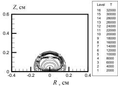
Рис.11. Пространственное распределение температуры T [K] в лазерном факеле на момент времени t=0.53 мкс (  $q_{Laz}=2\times10^7$  Вт/см²,  $E_{Laz}=0.3$  Дж,  $t_{Laz}=500$  нс,  $P_{\infty}=0.1$  атм)
