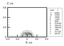
Рис.6. Пространственное распределение температуры T [K] в лазерном факеле на момент времени t=0.46 мкс (  $q_{Laz}=2\times10^7$  Вт/см²,  $E_{Laz}=0.3$  Дж,  $t_{Laz}=500$  нс,  $P_{\infty}=1$  атм)
