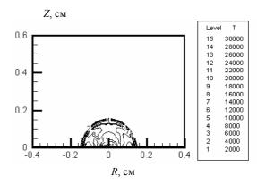
Рис.14. Пространственное распределение температуры T [K] в лазерном факеле на момент времени t=0.62 мкс (  $q_{Laz}=2\times10^9$  Вт/см $^2$ ,  $E_{Laz}=3$  Дж,  $t_{Laz}=50$  нс,  $P_{\infty}=1$  атм)
