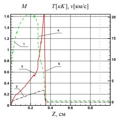
Рис.4. Распределения температуры T (1), продольной скорости v (2), числа Маха (1) в лазерном факеле вдоль оси Z на момент времени t=0.92 мкс при воздействии  $hv_2$  — лазера ( $q_{Laz}=2\times10^7\,\mathrm{Br/cm^2},~E_{Laz}=0.3\,\mathrm{Дж},~t_{Laz}=500\,\mathrm{Hc},~P_\infty=0.1\,\mathrm{atm}$ ); 4 — фронт контактной границы, 5 — фронт УВ
