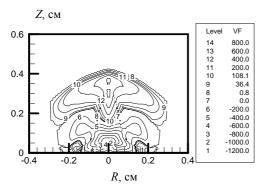
Рис.13. Пространственное распределение скорости вдоль оси v [м/с] в лазерном факеле на момент времени t=1.95 мкс (  $q_{Laz}=2\times10^7$  Вт/см²,  $E_{Laz}=0.3$  Дж,  $t_{Laz}=500$  нс,  $P_{\infty}=0.1$  атм)
