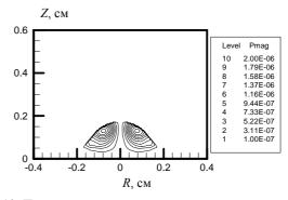
Рис.10. Пространственное распределение магнитного давления  $P_{MA\Gamma}$ [атм] в лазерном факеле на момент времени t=2.14 мкс (  $q_{Laz}=2\times10^7$  Вт/см²,  $E_{Laz}=0.3$  Дж,  $t_{Laz}=500$  нс,  $P_{\infty}=1$  атм)
