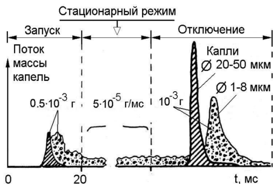
Рис. 7. Характер выбросов капель в зону 1 из сопла ЖРДМТ MBV10N [2]
