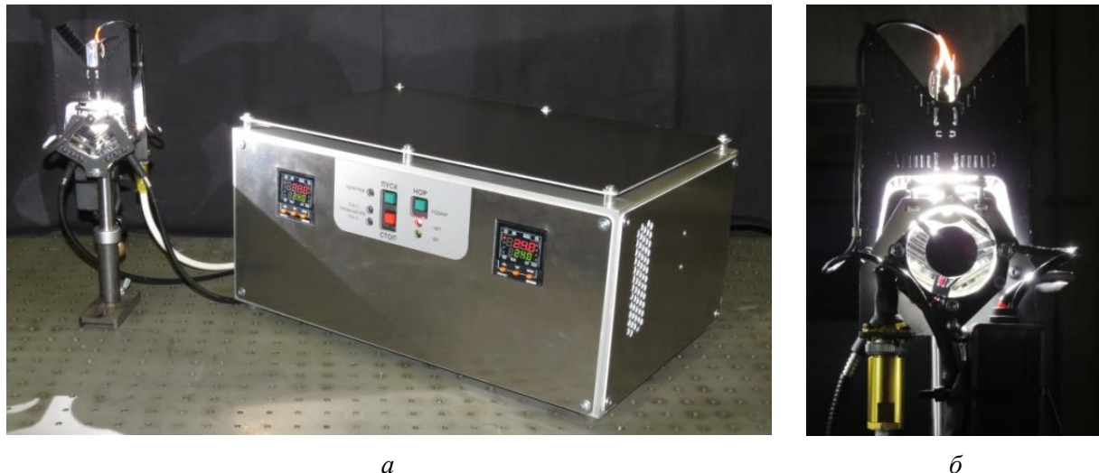
Рис. 7. Прототип лазерно-плазменного широкополосного источника излучения с пересекающимися лазерными лучами. (а) – общий вид излучателя открытого типа и служебного модуля. (б) – излучатель открытого типа, предназначенный для работы в составе оптического прибора
