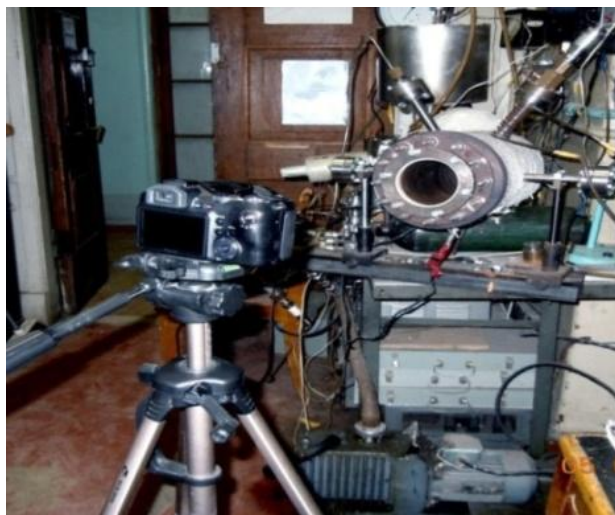
Рис. 2. Использование скоростной видеокамеры для съемки процесса горения
