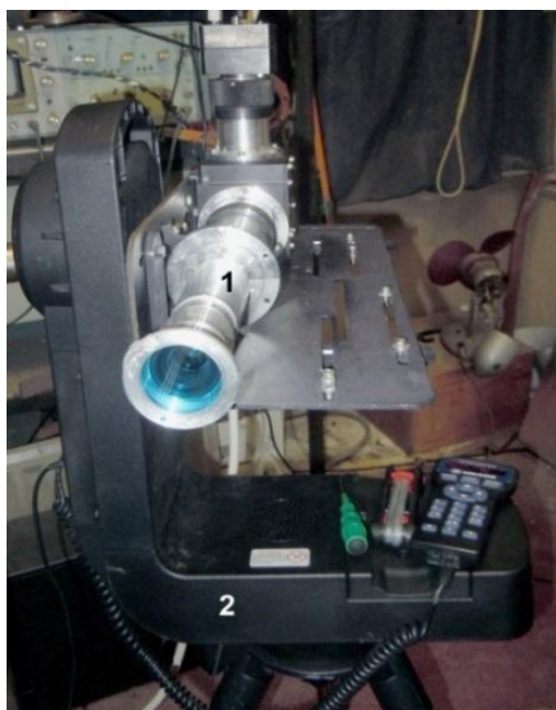
Рис. 3. Гиперспектрометр ИК-ВИДЗ (1) на поворотном устройстве (2)
