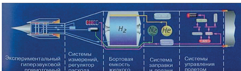
Рис. 9. Гиперзвуковая летающая лаборатория ЦИАМ (1991)
