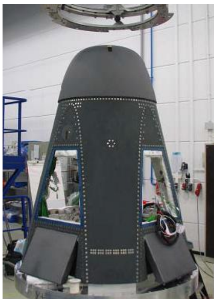
Рис. 2. Сборка ЛА EXPERT [1]
